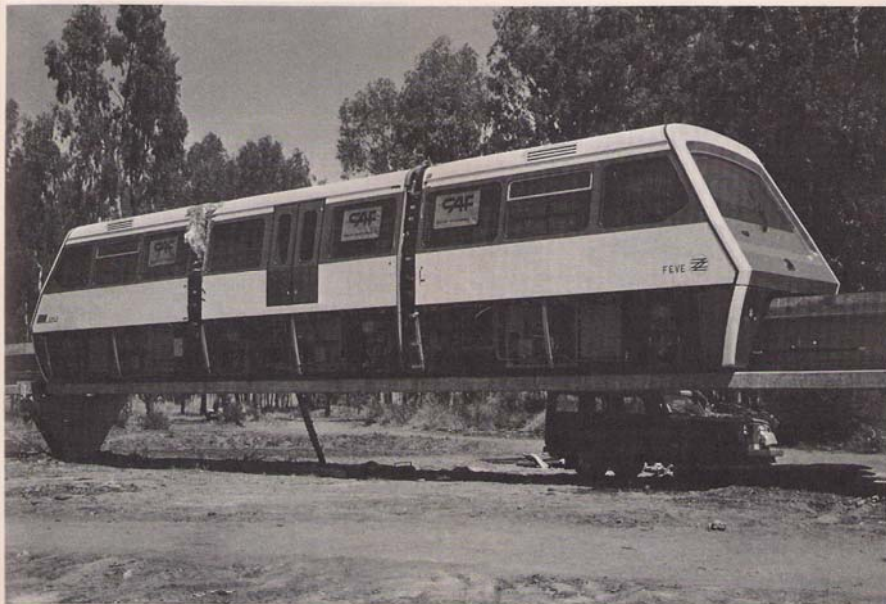
Prototipo de un vagón-cabina del EM-403, con la carena descubierta para poder apreciar los equipos bajo bastidor. A este modelo seguirá el EM-500 para largas distancias.
